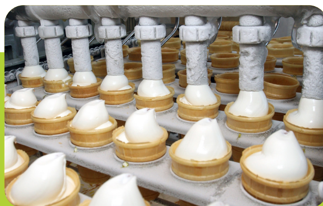
Nettoyage des buses de conditionnement de crème glacée pour une garantie de poids constants.
